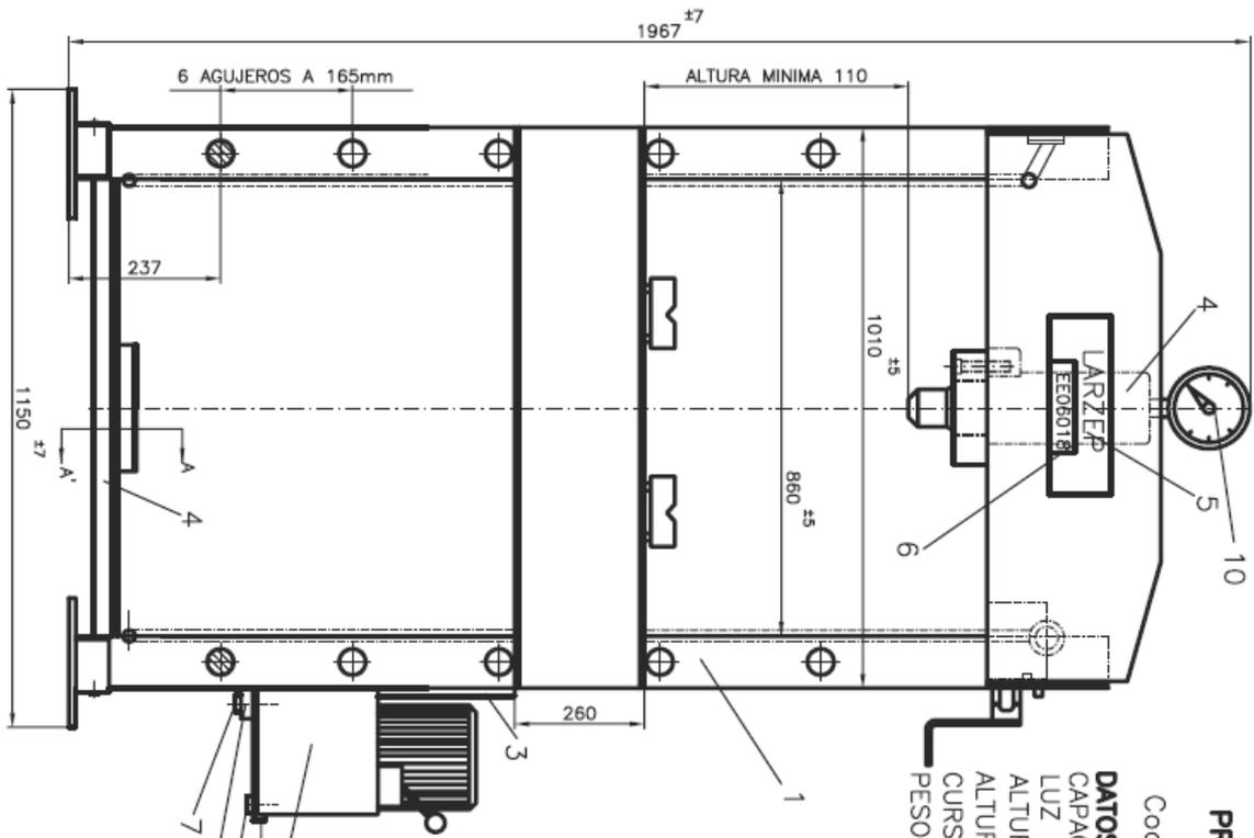
**PRESA HIDRAULICA DE COLUMNA**
